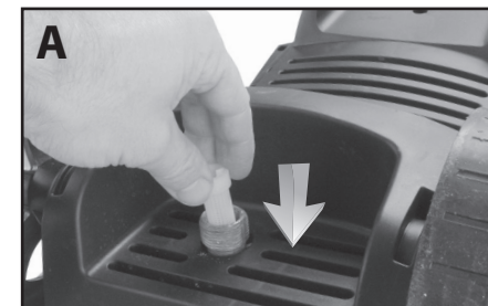
Montage des Druckschlauchs zur Pistole beim Modell HPC 1800, Abb. 8
