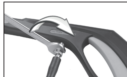
Montage des Druckschlauchs zur Pistole beim Modell HPC 1800, Abb. 8
